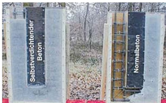
öntömörödő és normál beton térfogat-kitöltése
