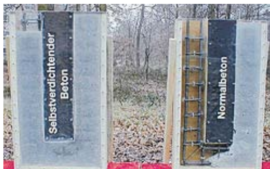
öntömörödő és normál beton térfogat-kitöltése
